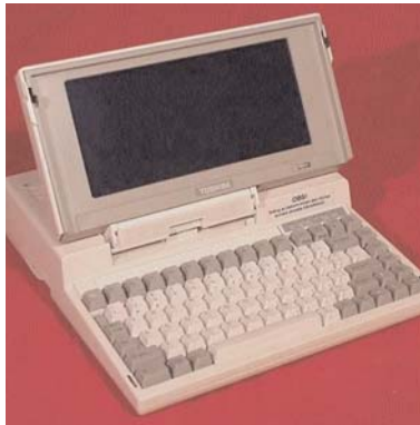
Первый в мире ноутбук с 2,5-дюймовым жестким диском (модель T 1200 XE)
